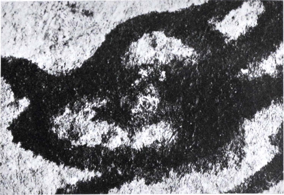
Abb. 13. ^1\text{Na} - ^2\text{khi} -Handschrift 8161; Tierkopf von Blatt 5, ungleichmäßiges Papier, ausgelaufene Schrift; geringe Schreibfestigkeit. 7-fach
